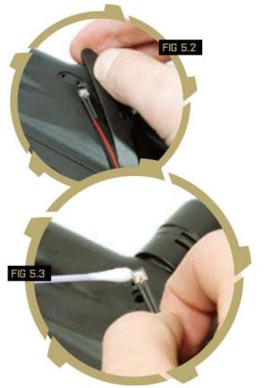
Retirez le rétenteur de billes et à l'aide d'un coton tige sec, nettoyez le rétenteur et son logement dans le corps du Etek Ego. Replacez le rétenteur propre dans son logement [VOIR FIGURE 5.4] et réinstallez la cellule dans son logement, en faisant passer les fils dans la gorge [VOIR FIGURE 5.5].
