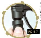
Insérez une Allen clé 1/8" dans la vis de réglage dans la partie inférieure du régulateur, et tournez la dans le sens horaire pour la faire sortir de son logement [VOIR FIGURE 5.11] et tirez là lorsqu'elle ne remonte plus seule.
